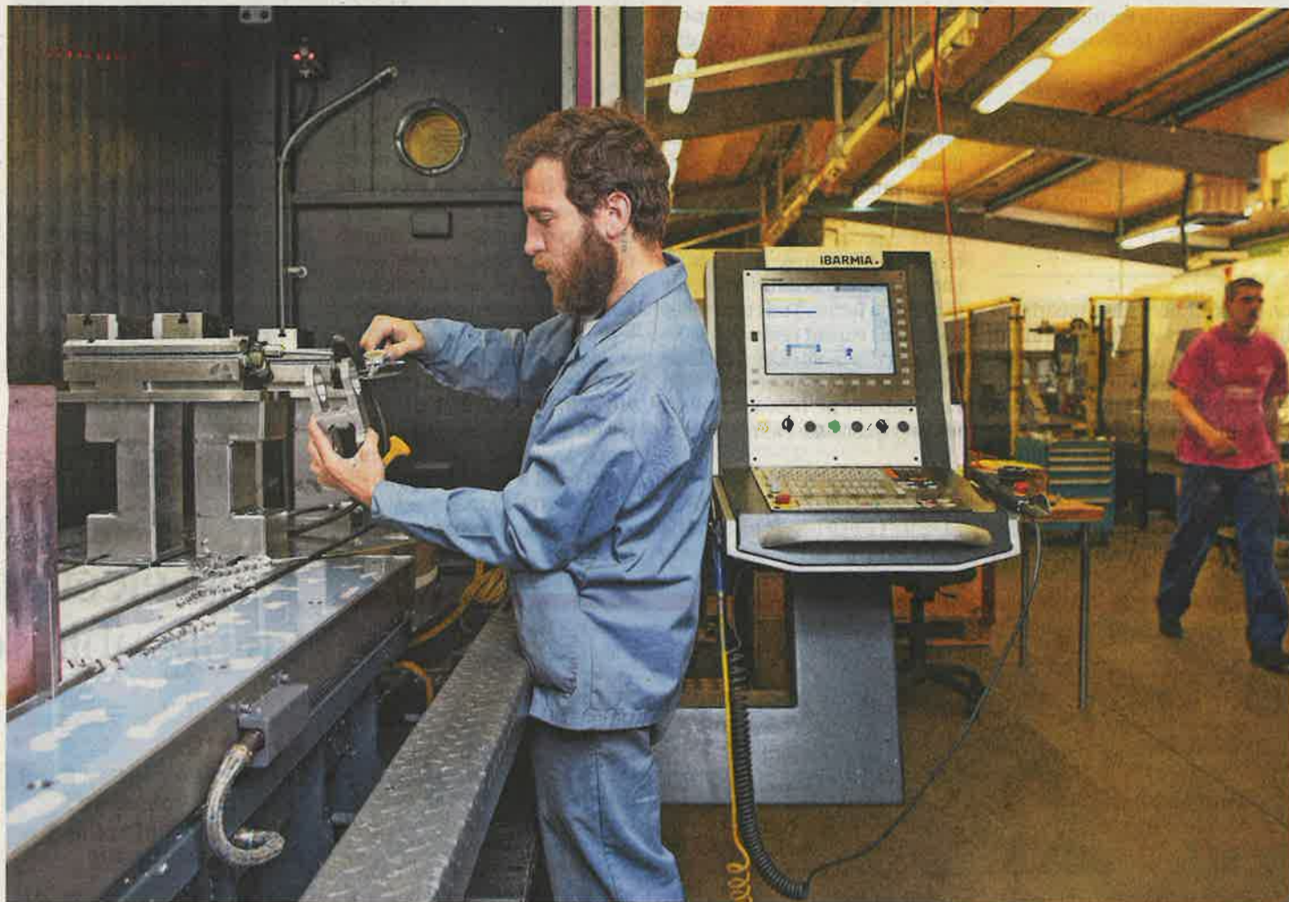
L'entreprise investit beaucoup dans des machines dernier cri. Ici, un centre d'usinage 5 axes avec une course de 3 m. JEAN-PAUL GUINNARD
